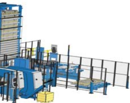
Il grande sistema Night Train FMS automatizza i sistemi di gestione dei materiali e di informazione dello stabilimento e le operazioni di punzonatura, combinando le singole fasi di produzione in un unico processo flessibile. È dotato di oltre 400 cassetti per il deposito dei materiali.
