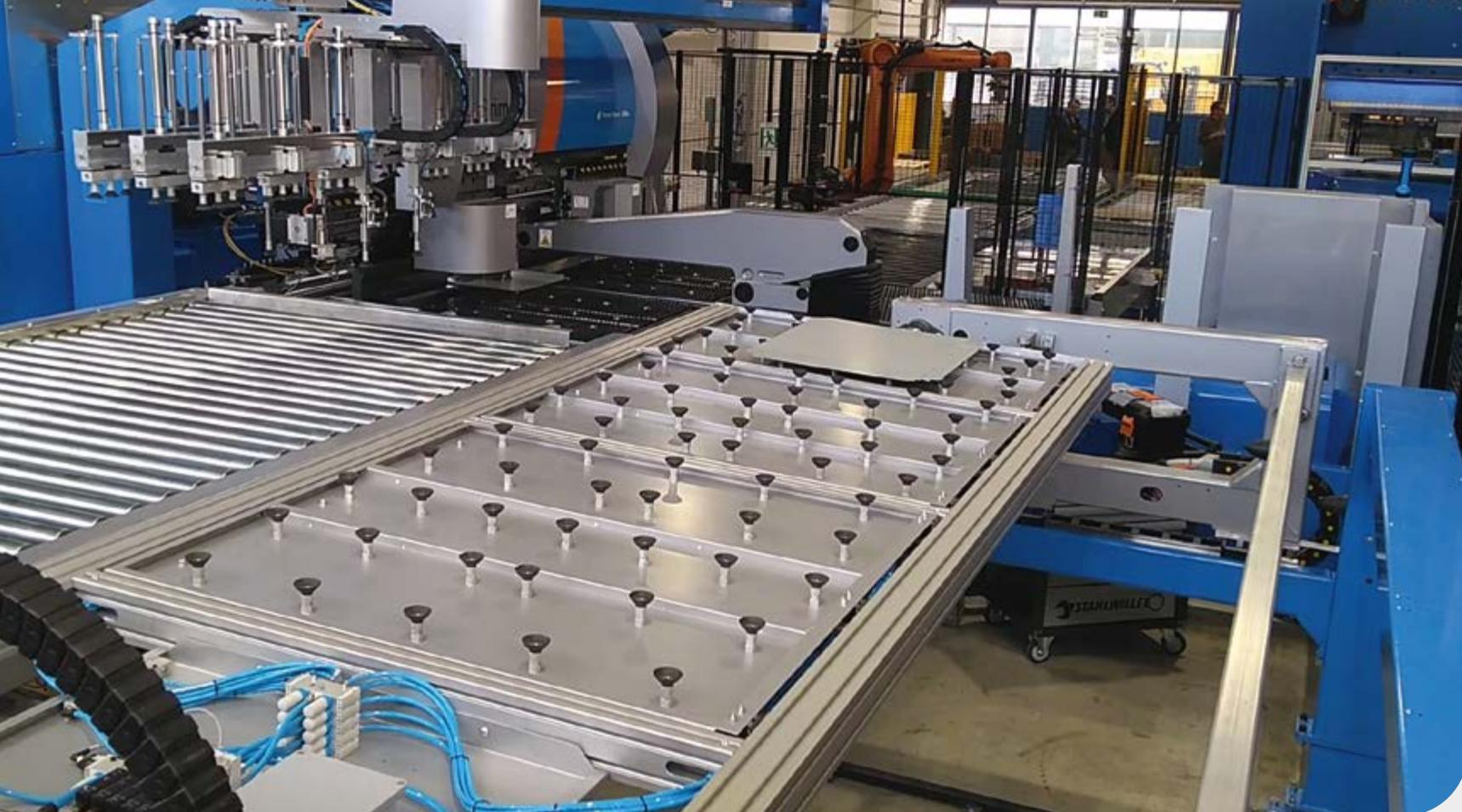
Il sistema di piegatura automatico installato presso Schulthess si compone di una pannellatrice servoelettrica EBe4FM, una pressa piegatrice eP0520, un robot industriale a 7 assi su rotaie e un'area di pallettizzazione con alimentazione automatica dei pallet. Qui, una parte viene ribaltata dal dispositivo di ribaltamento della EBe per il centraggio sul dispositivo di prelievo e centraggio.
