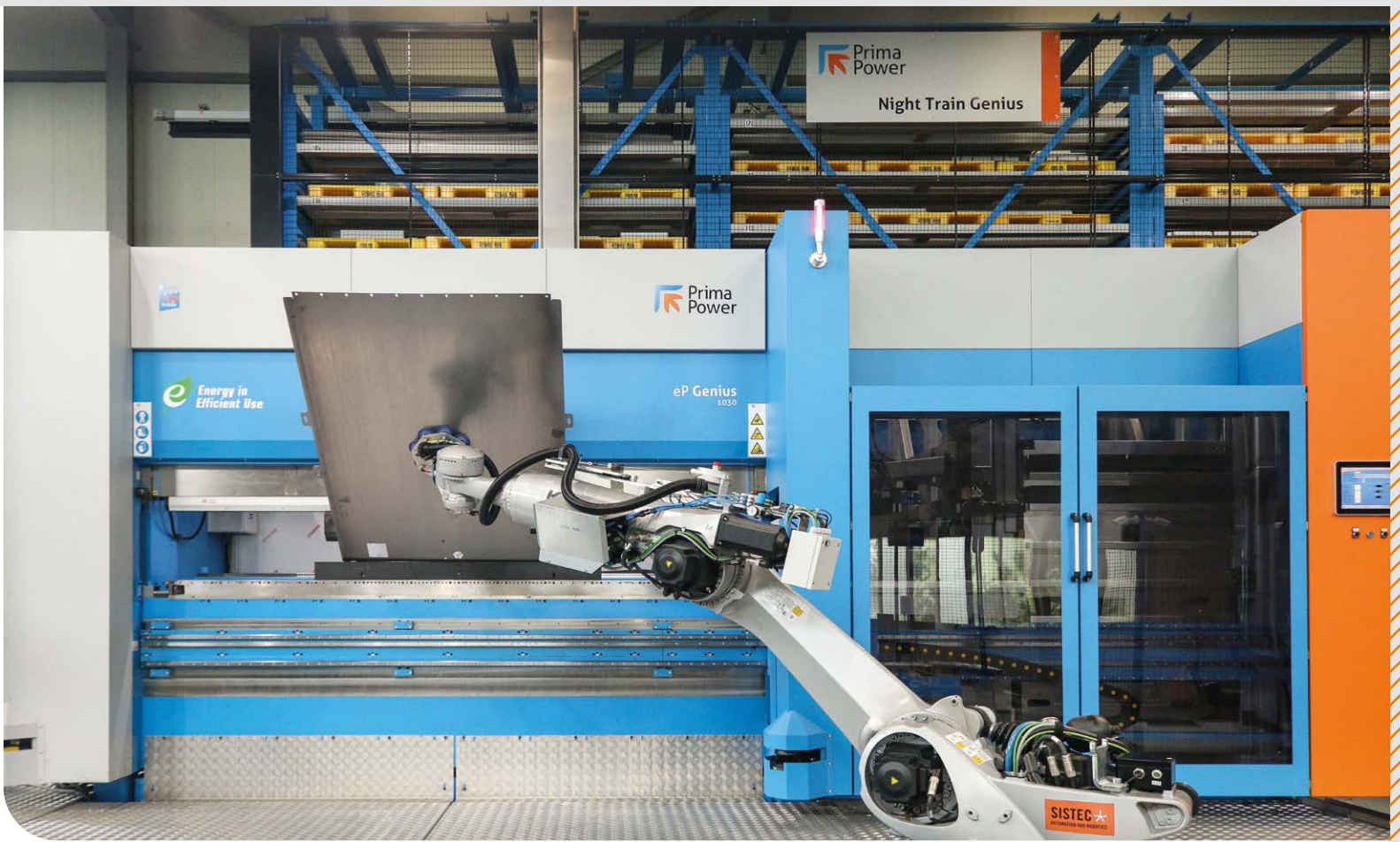
Presse plieuse eP Genius 1030 avec magasin de changement d'outils automatique et robot anthropomorphe 7 axes installée chez WOOJIN PLAIMM.
