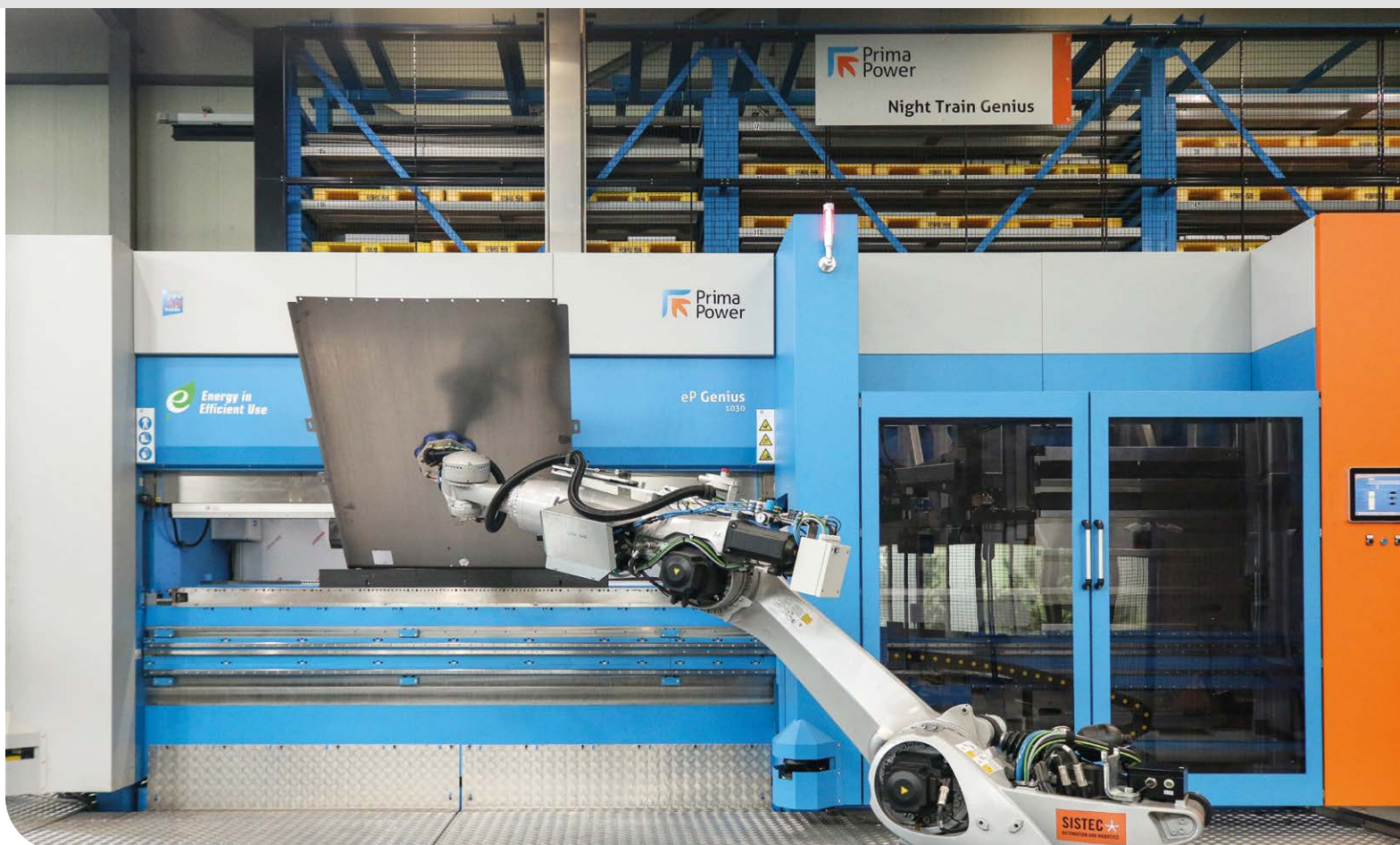
La pressa piegatrice eP Genius 1030 con magazzino di cambio utensili automatico e robot antropomorfo a 7 assi installata presso WOOJIN PLAIMM.
