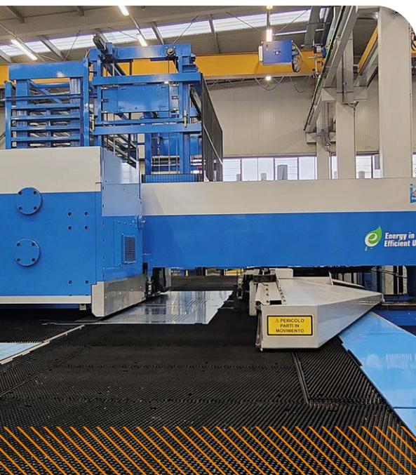
Die Stanzeinheit in der PSBB-Linie führt mehrere Bearbeitungsvorgänge, wie Gewindeschneiden oder Umformen, an einer einzigen Station durch und steigert so die Gesamteffizienz des Produktionsprozesses
