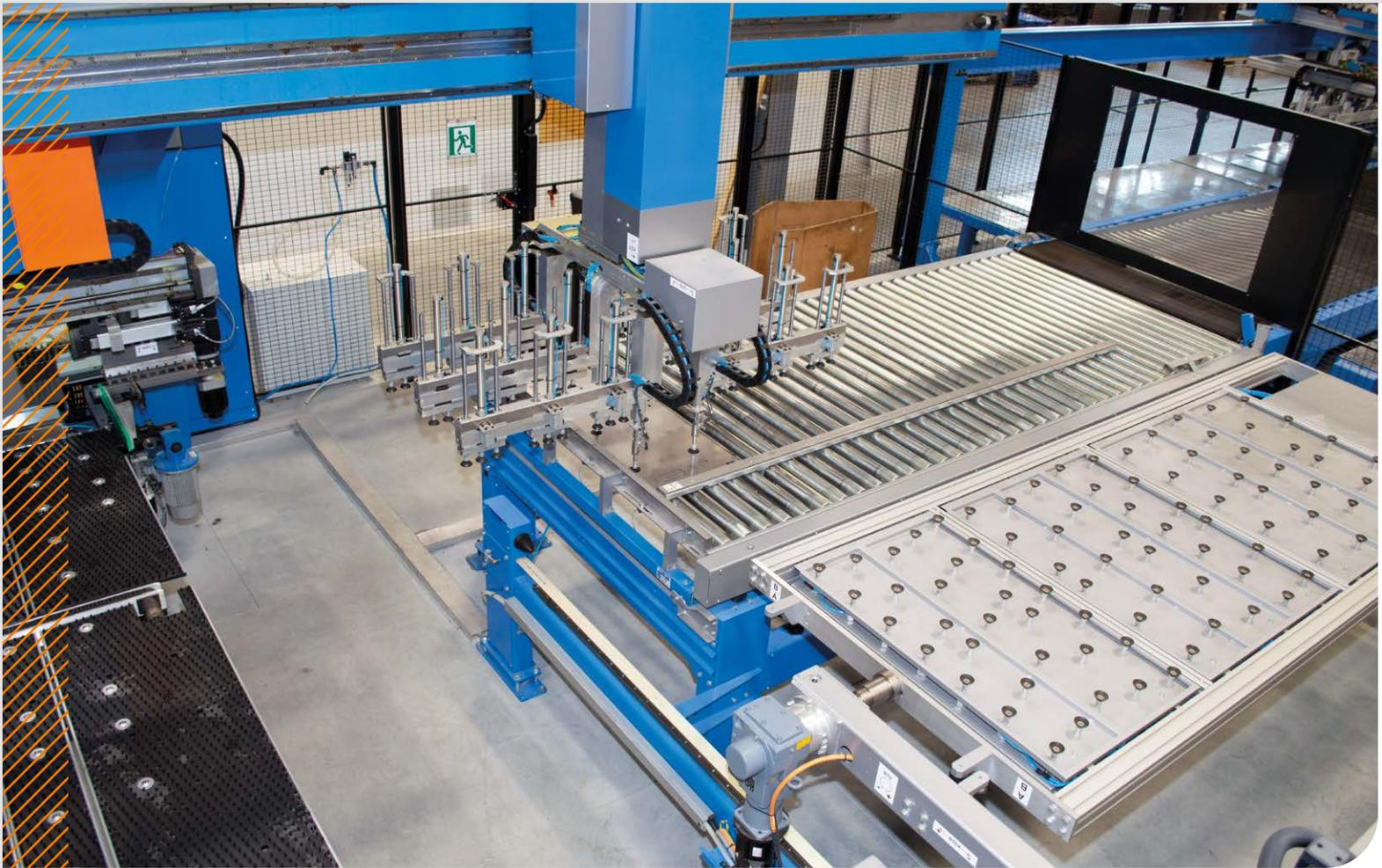
Die Vorrichtungen für Teileentnahme und Stapeln versorgen einen Puffer für Halbfertigteile, um einen reibungslosen und kontinuierlichen Fertigungsfluss zu gewährleisten.
