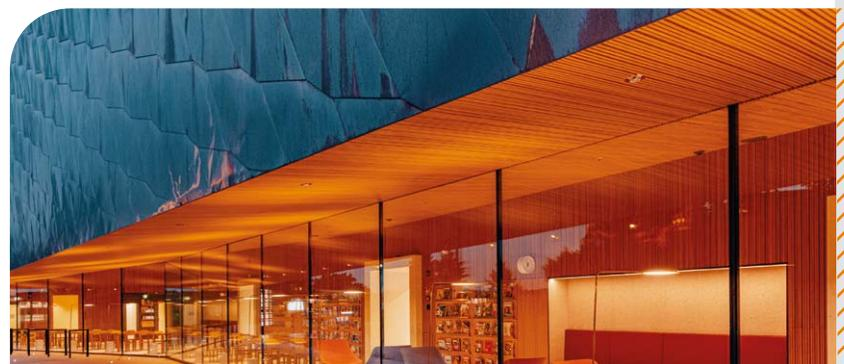
Bibliothèque centrale Kirkkonummi, Fyyri. Matériaux : Panneaux en cuivre et lamelles en aluminium anodisé noir, perforés sur mesure. Détails intérieurs en laiton.
