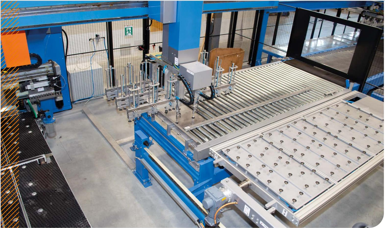
Les dispositifs de prélèvement et d'empilage des pièces maintiennent une zone tampon pour les pièces semi-finies, ce qui garantit un flux de fabrication fluide et continu
