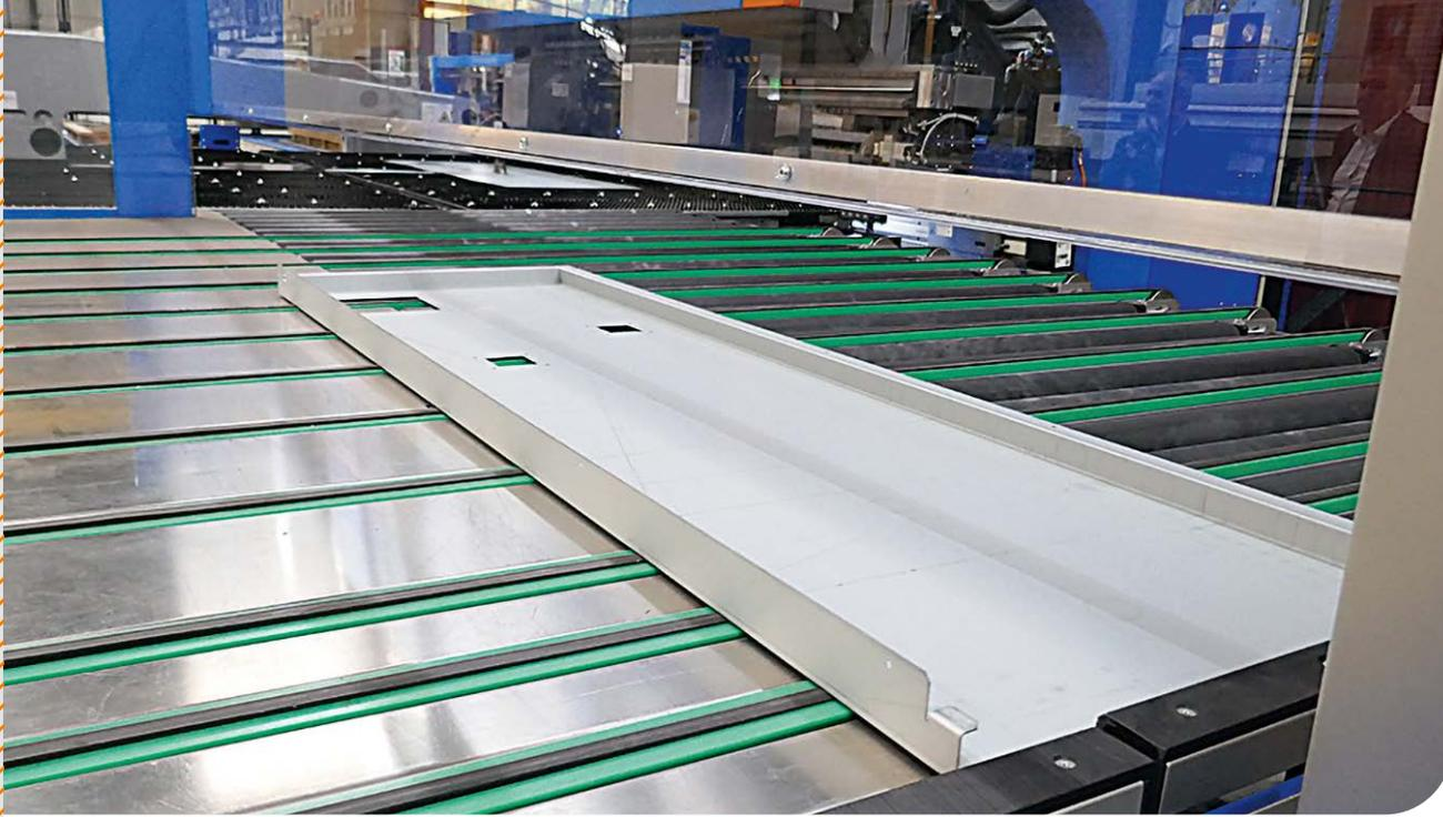
Une zone d'accumulation des pièces à traiter permet à l'opérateur de disposer de temps entre les phases de déchargement. Avec l'aimable autorisation de Tôlerie
