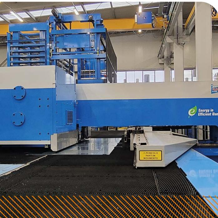
L'unité de poinçonnage de la ligne PSBB effectue plusieurs opérations de traitement, telles que le filetage ou le formage, sur une seule station, ce qui permet d'améliorer l'efficacité globale du processus de production
