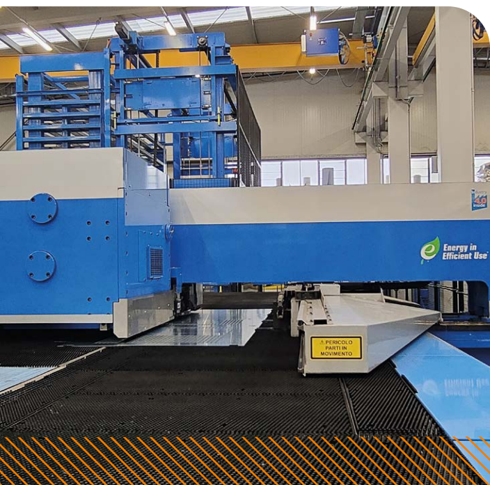
L'unità di punzonatura sulla linea PSBB esegue più operazioni di lavorazione, come filettatura o formatura, su un'unica stazione, migliorando così l'efficienza complessiva del processo produttivo
