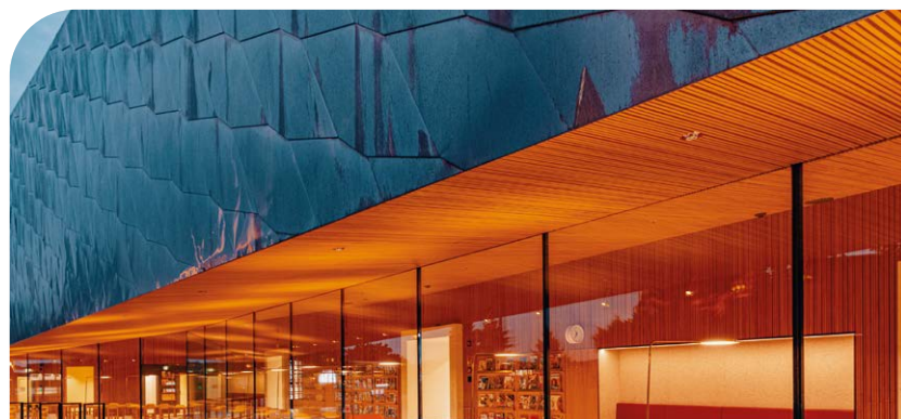
Biblioteca principale Kirkkonummi, Fyri. Materiali: pannelli in rame e listelli in alluminio anodizzato nero, perforati su misura. Dettagli interni in ottone
