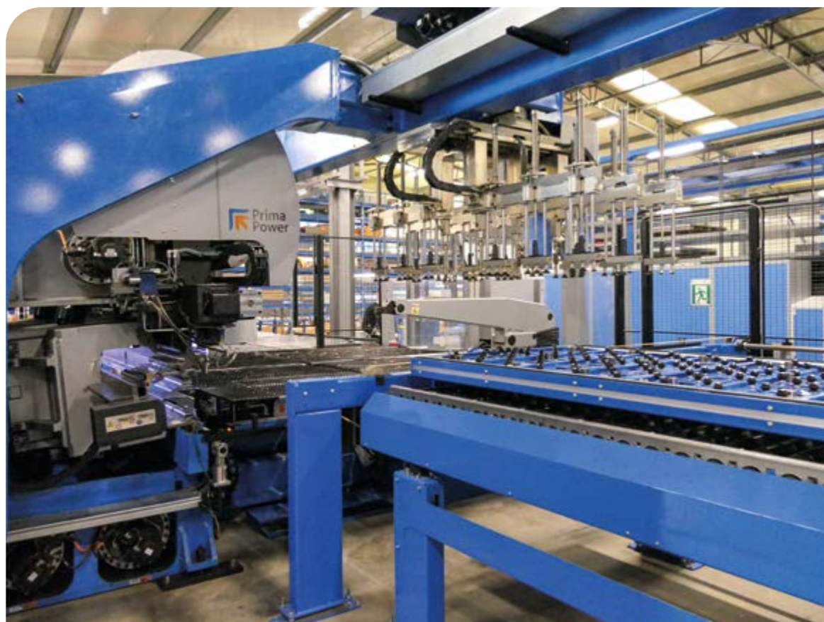
Il sistema PSR di Prima Power automatizza la presa, l'impilamento e il buffering intermedio dei pezzi tra le macchine di punzonatura/cesoiatura e le pannellatrici.
