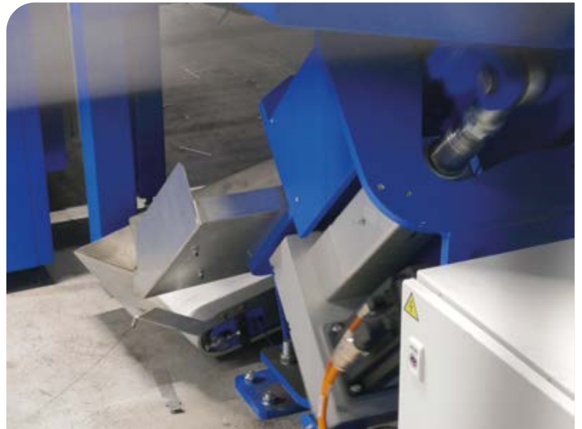
Das Reststreifenschersystem ermöglicht die automatische Entfernung sämtlicher Restgitter.
