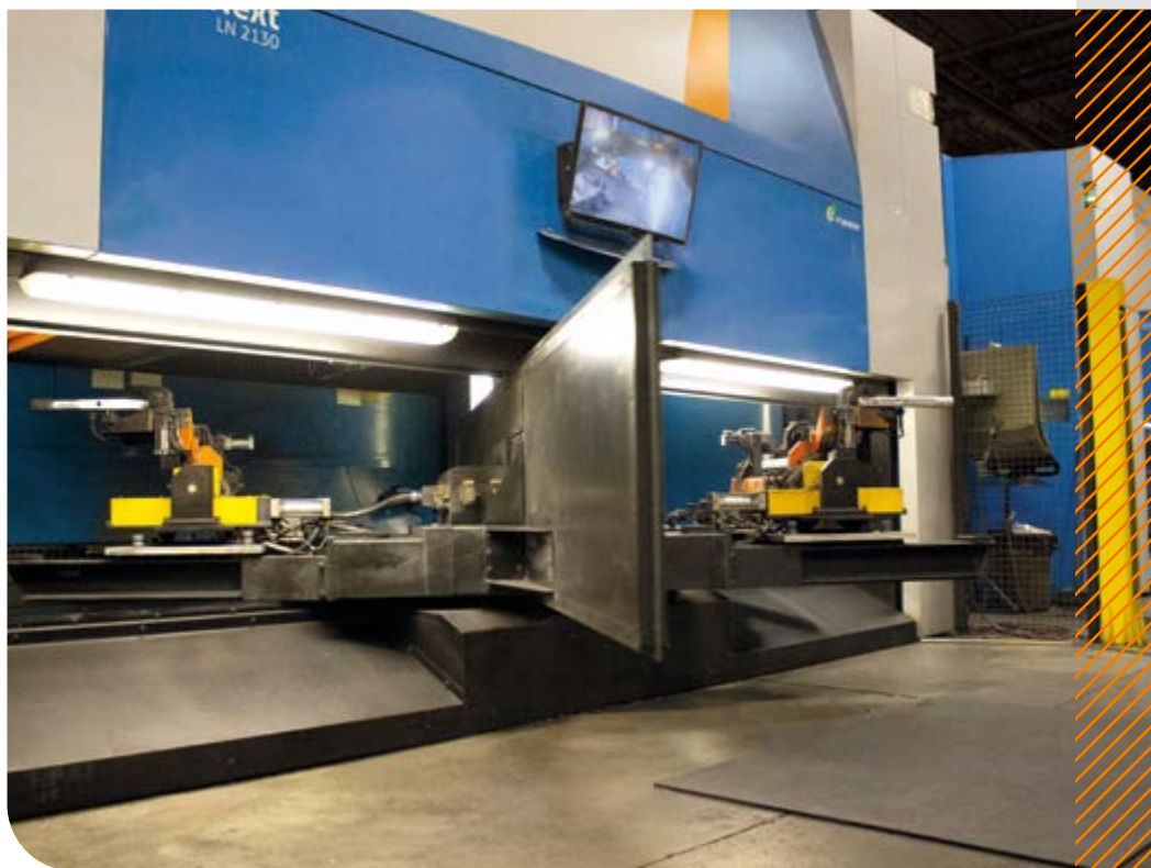
Die bei LSI installierten Laser Next-Systeme verfügen über einen Drehtisch und können von Bedienern oder Robotern in maskierter Zeit be- und entladen werden.
