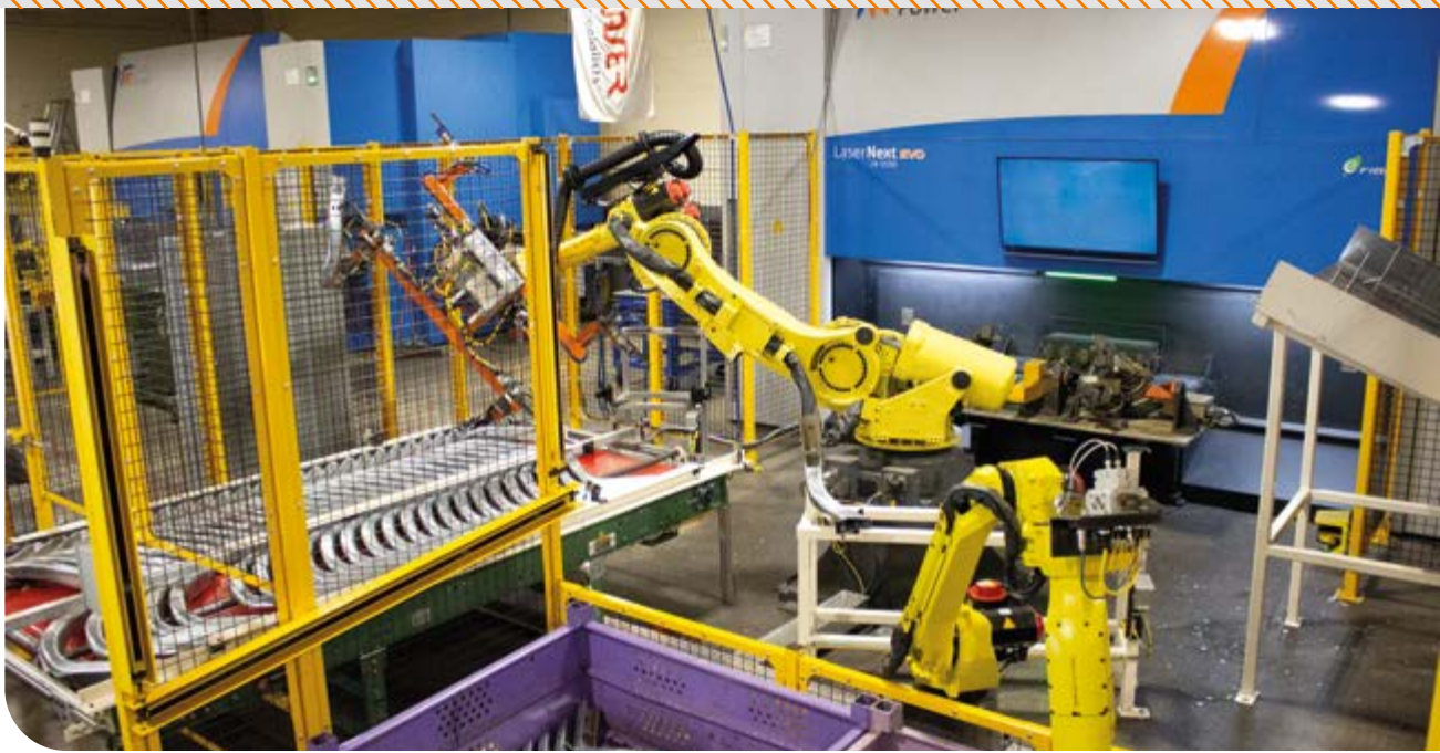
Zwei Roboter-Automatisierungszellen, die in Lasersysteme von Prima Power integriert sind, helfen LSI dabei, Engpässe zu vermeiden, die Effizienz der Arbeitsabläufe zu steigern und den Produktionsbetrieb rund um die Uhr aufrechtzuerhalten.
