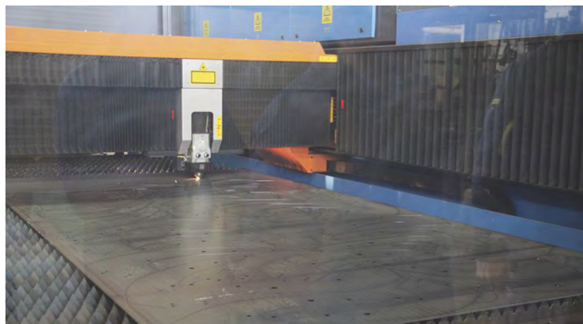
Prima Power Platino è stato scelto da Badalini nella versione LP2040, con campo di lavoro di 4.000 x 2.000 mm.
