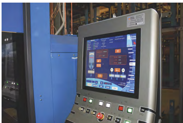
Vista controllo numerico proprietario P30L installato insieme al Platino, facile da usare ed ergonomico (con schermo touch da 17" e trackball).
