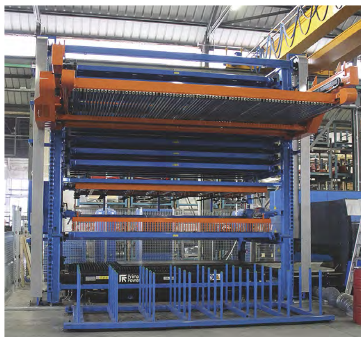
Dettaglio torre d'automazione da 10 pallet in asservimento della taglio laser Prima Power Platino.
