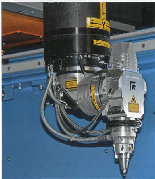
Der Laserkopf wird mit Servo-Direktantrieben bewegt, ist aus Aluminium und durch zwei magnetische Kupplungen gegen Kollisionen geschützt.
