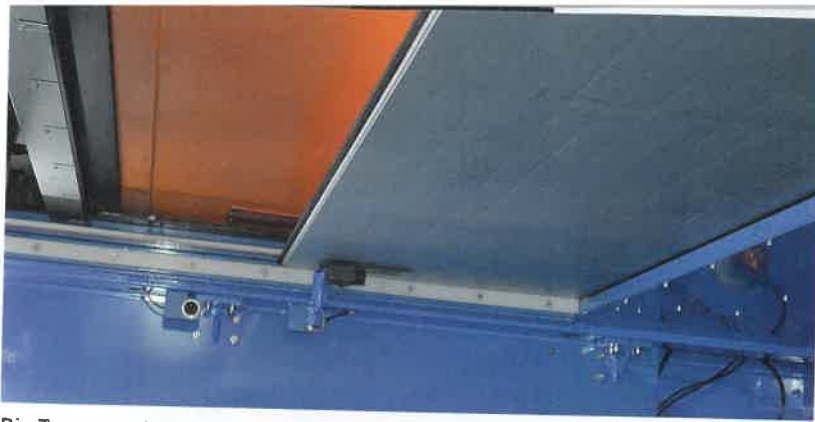
Die Trennwand sowie die verfahrbare Decke sind absolut sicher gegen Laserstrahlung, sodass in der zweiten Kabine gearbeitet werden kann.
