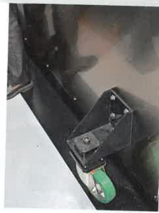
Die Trennwand ist auf Rollen verfahrbar. Die Durchtrittsöffnung für den Laserkopf wird motorisch geöffnet.
