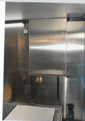
Die Trennwand ist auf Rollen verfahrbar. Die Durchtrittsöffnung für den Laserkopf wird motorisch geöffnet.
