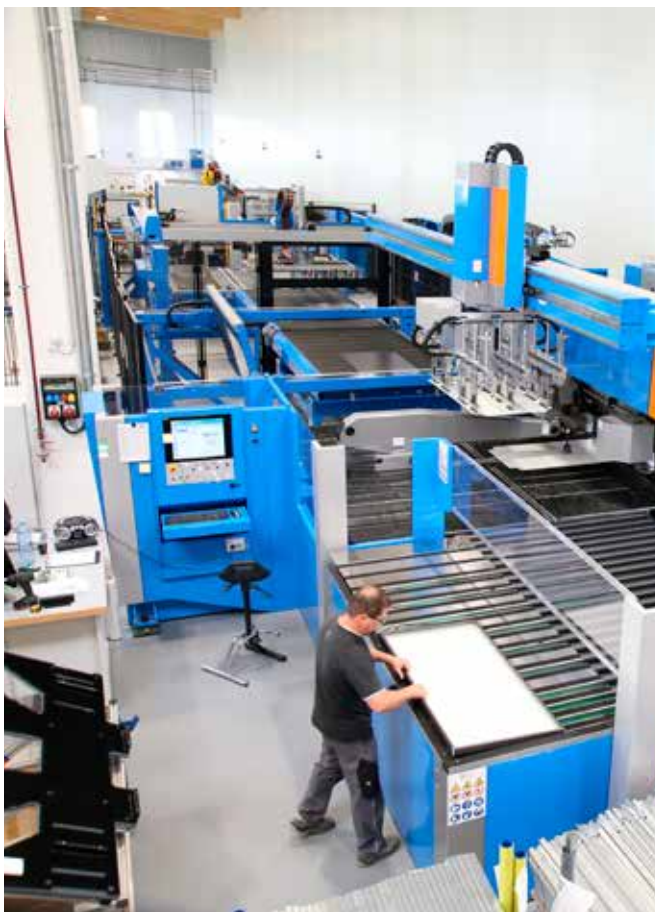
Optimaler Produktionsfluss: Auch das vollautomatische Biegezentrum EBe 5.3 von Prima Power wird über den Greif- und Stapelroboter PSR mit den gestanzten Platinen aus dem Night Train versorgt.
