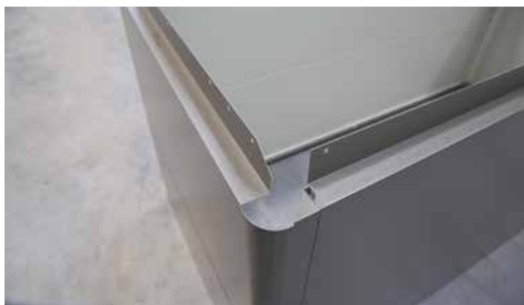
Für die Fertigung von Teilen wie diesem Korpus (links) oder dem neuen Floraboard (rechts) benötigt das neue Biegezentrum im Vergleich zu herkömmlichen Abkantpressen weniger als ein Drittel der Zeit – das aufwendige Werkzeugrüsten bei der Abkantpresse noch gar nicht eingerechnet.
