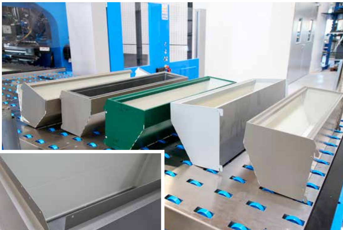
Für die Fertigung von Teilen wie diesem Korpus (links) oder dem neuen Floraboard (rechts) benötigt das neue Biegezentrum im Vergleich zu herkömmlichen Abkantpressen weniger als ein Drittel der Zeit – das aufwendige Werkzeugrüsten bei der Abkantpresse noch gar nicht eingerechnet.
